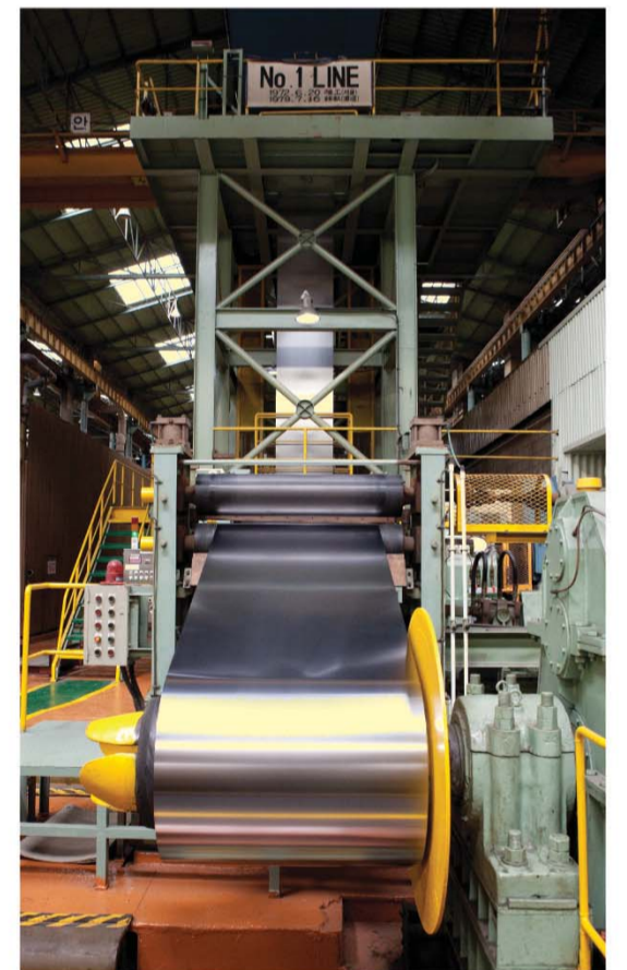
1972년 6월, 동양석판은 연속광복전기 석도금 설비(사진)를 신규 설치하고 준공함으로써 국제 규격에 맞는 광복 석도강판 공급 체제를 갖추었다.
